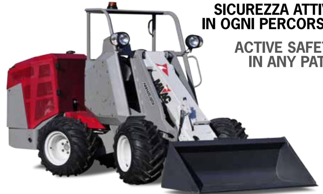
La possibilità di sterzare utilizzando solo le ruote anteriori assicura a Mangusta una stabilità di spostamento che raggiunge i livelli di prestazione delle categorie superiori. Grazie a questa caratteristica, il mezzo può permettersi in sicurezza una velocità su strada di 35 km autolimitati.
